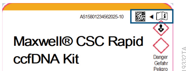
Obrázek 4. Štítek sady indikující čárový kód k naskenování. Čárový kód k naskenování pro spuštění purifikačního cyklu je zobrazen v pravém horním rohu štítku sady v modrém rámečku.
