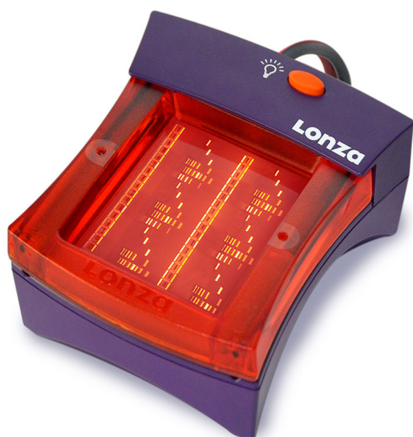
Obr. 10 FlashGel systém a DNA kazetka pro rychlou gelovou elektroforézu nukleových kyselin
