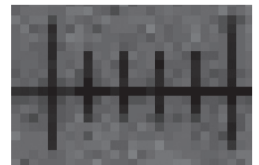
Reálné rozlišení obrazu při 5 mikronech – každý pruh je široký 5 mikronů.
